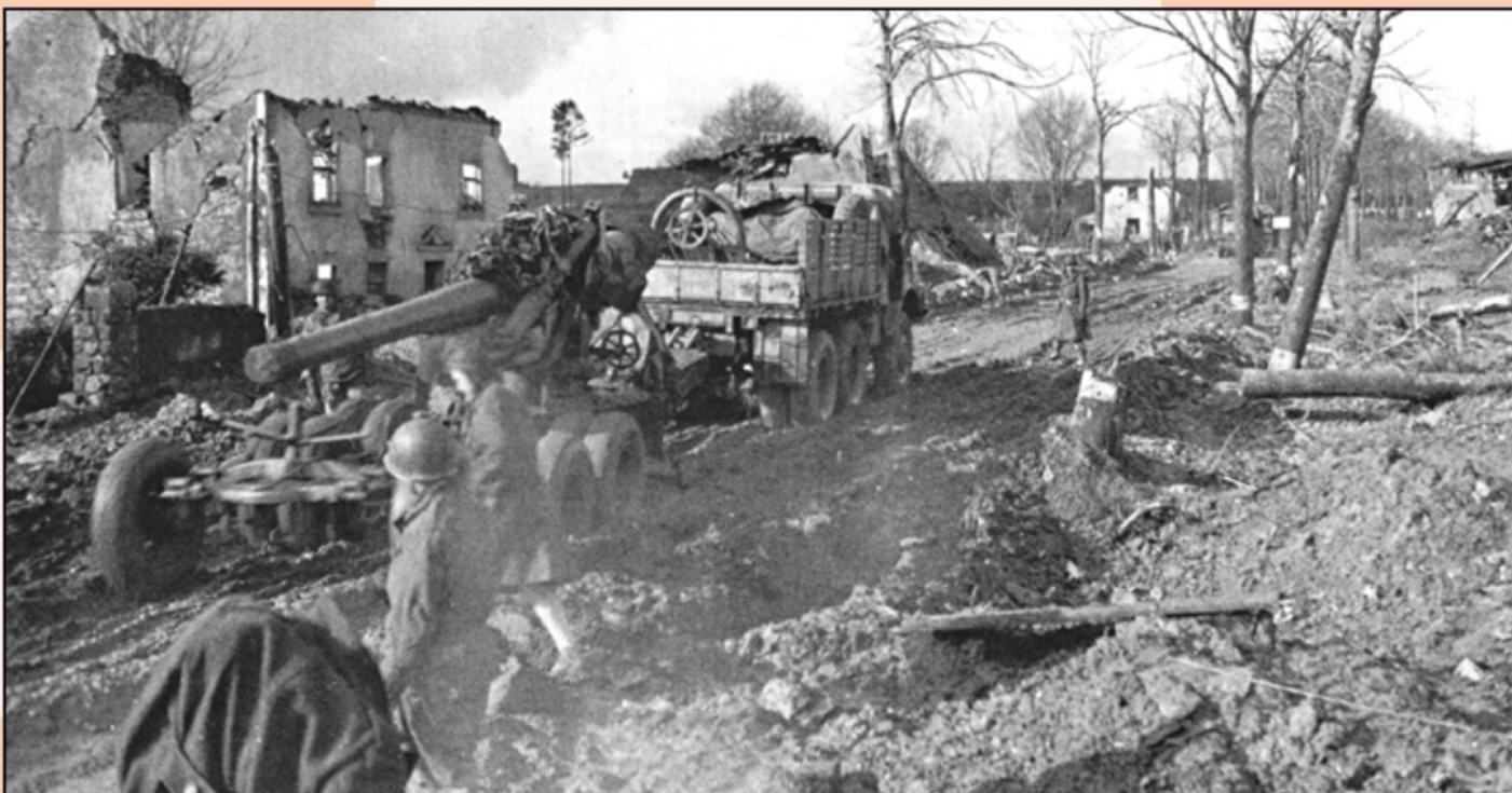
Een NO bezig met het werk waarvoor hij was ontworpen: een 155 mm M1 Long Tom door de modder trekken. De locatie: St. Vith, België, 10 februari 1945. Het kanon is met een Mack koppeling aan de NO gekoppeld, de voorwagen van het kanon hangt er achter.
