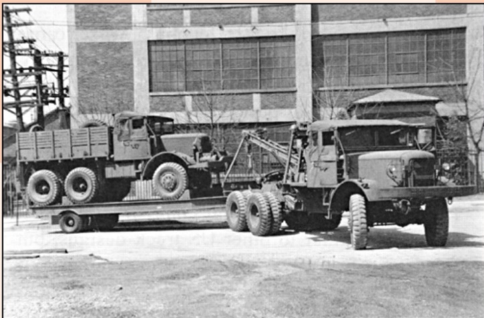
◀ Het enige prototype van de NO-4 takelwagen voor de Mack fabriek in Pennsylvania. Op de LBST-1 aanhanger staat een NO-2. Deze aanhanger was door Mack speciaal ontwikkeld voor gebruik door de NO. De NO-4 en NO-5 hadden geen frontlier
